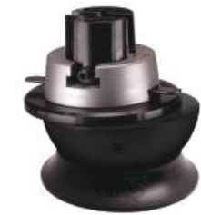
Positioning Vice 顕微鏡下での作業中に、ワークピースを視野の中心に保つためのバイスです。中心を保つ事により作業時間を節約できます。 GRS製の中で最も最大でも最も安定性に優れたバイスです。 #003-431 ¥319,000 (税別) サイズ: Φ147mm バイス幅: 76mm 最大開口: 89mm バイス深さ: 46mm 重量: 約18.2kg
