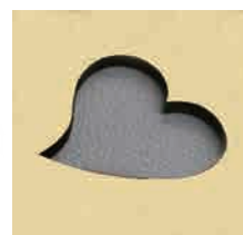
リングの切抜き/真鍮/5mm /加工時間約3分 20W
