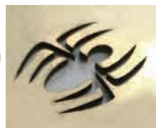
切抜き加工 蜘蛛 真鍮/厚み1.0mm/サイズ 高さ12mm/3分23秒 50W
