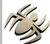
切抜き加工 蜘蛛 真鍮/厚み1.0mm/サイズ 高さ12mm/3分23秒 50W
