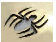
切抜き加工 蜘蛛 真鍮/厚み1.0mm/サイズ 高さ12mm/3分23秒 50W
