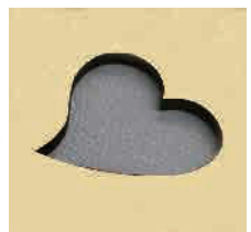
リングの切抜き/真鍮/5mm /加工時間約3分 20W
